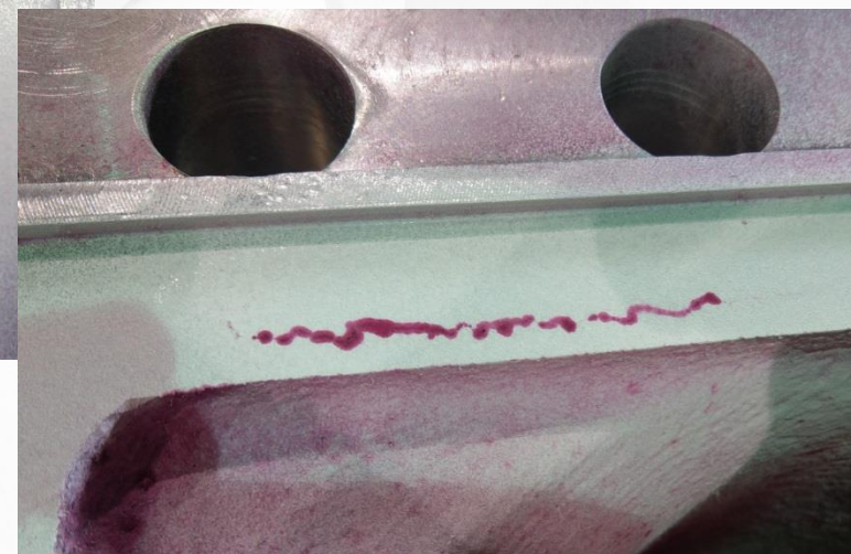
Округлые и линейные индикации в основном металле
