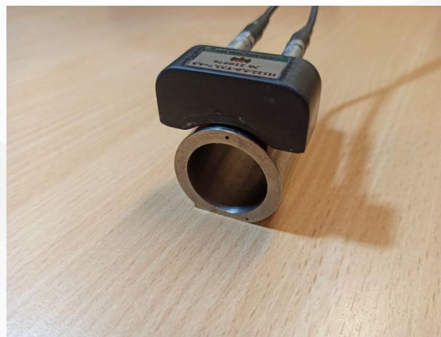
Хордовый преобразователь и настроечный образец d=33.7 \times 4.5 мм
