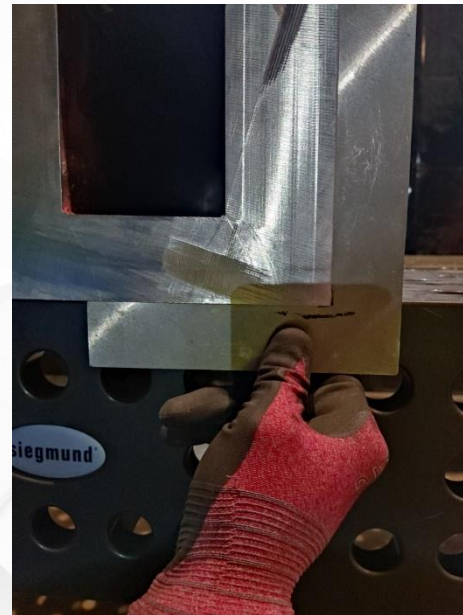
Измерительный контроль. Проверка перпендикулярности верхней и нижней стенок
