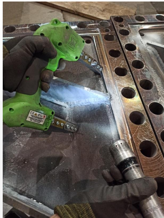
Проведение магнитопорошкового контроля сварного соединения
