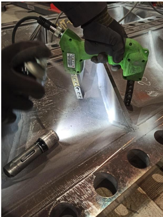
Проведение магнитопорошкового контроля сварного соединения
