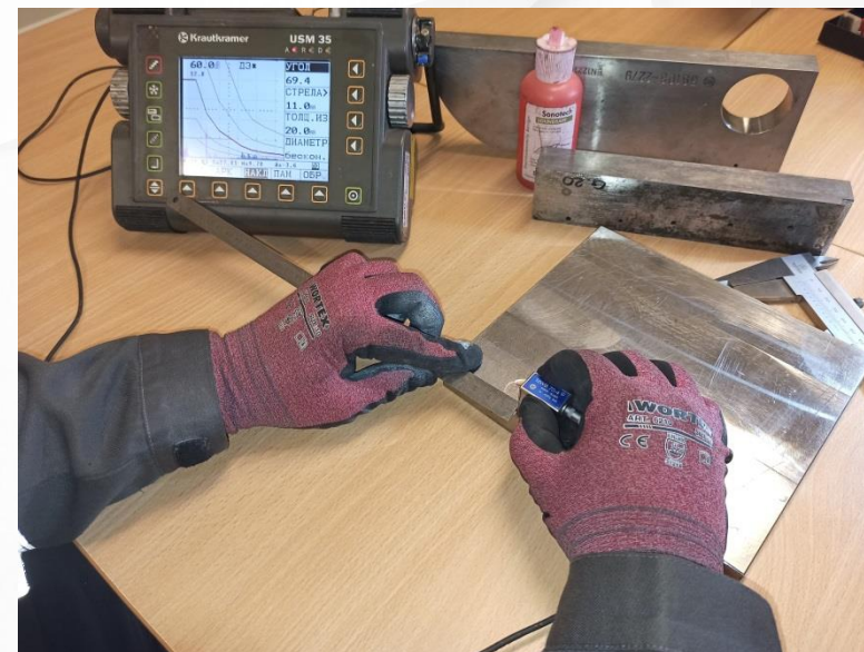
Выполнение настройки DAC для контроля сварных соединений
