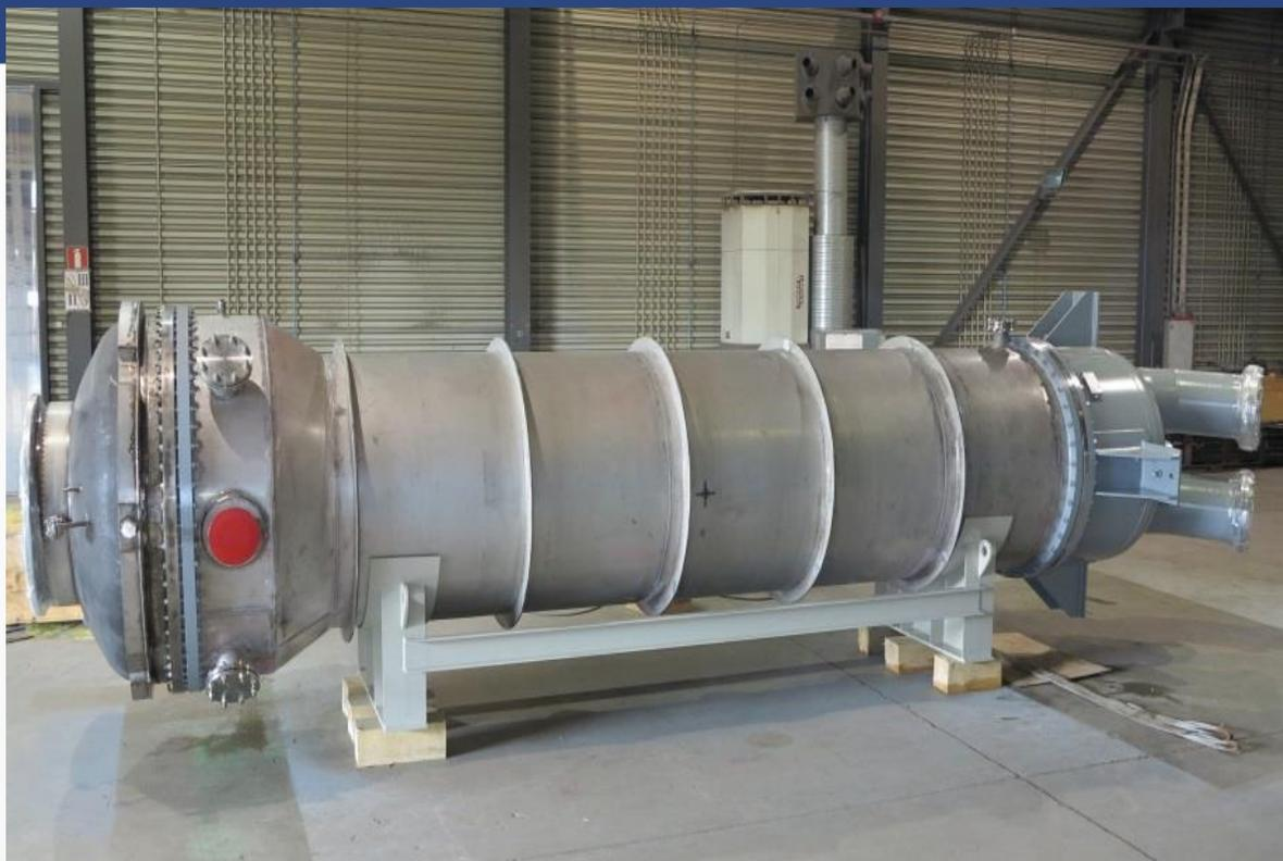
В условиях требований повышенной механической прочности, стойкости к агрессивным средам, морской воде применяется теплообменная аппаратура, изготавливаемая из дуплексных и супердуплексных сталей. На ТМТ освоено производство теплообменников и сосудов различного назначения, трубопроводов, деталей насосов из **Duplex 2205** а также из **Super Duplex 2507**, нашедших широкое применение в оборудовании для химической и нефтехимической отраслей.
