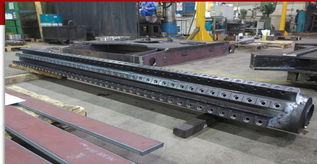
**ИСПОЛНЕНИЕ** Коллекторы с гребенками, традиционная конструкция, методы контроля: МТ, РТ и УТ
